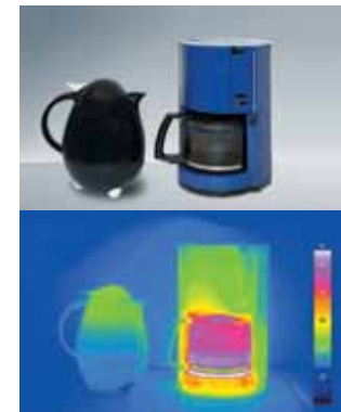
Passiv = Warmhalten in der Isolierkanne Activ = Warmhalten durch Energiezufuhr
