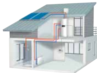
Brennwertkessel mit Solarthermie
