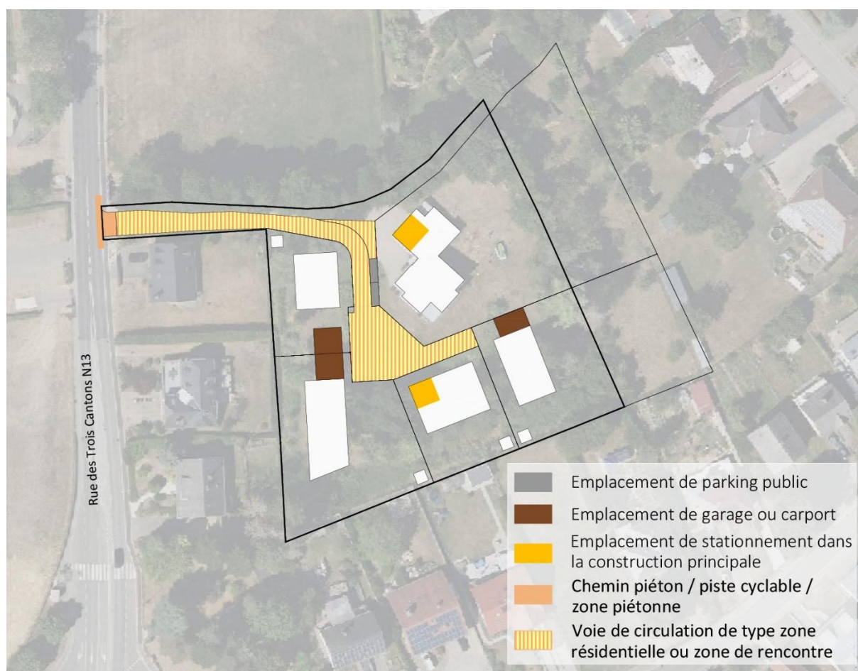
Figure 10 - Concept de mobilité et de stationnement privé et publics, source : Planetplus, septembre 2024
